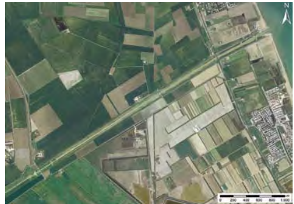
Fig. 3.5 - Tratto terminale del Cervaro; per facilitare il deflusso verso mare, molti dei fiumi del Tavoliere sono stati canalizzati nella loro parte terminale.
